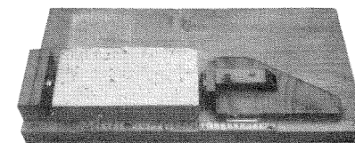
Fig. 11. Måleapparat til måling af mursten
